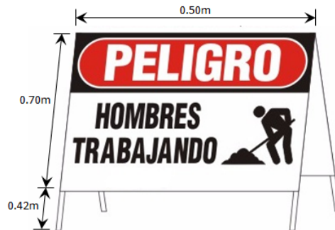
Figura: Señalización tipo caballete
